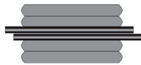
HVS protupožarni jastučići za kabele klasa S 90 u kombinaciji sa sustavom HSI 150 prema DIN 4102-9
