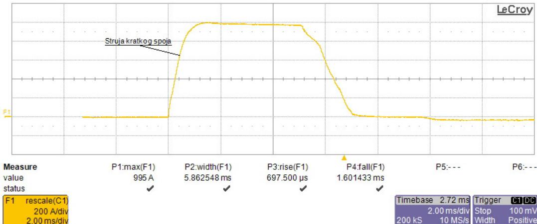
5.4. Učinjen je kratki spoj između "+" i "-" sabirnica na stezaljkama -X2:87,88, koje se nalaze iza prekidača -Q146 / Zaštitni prekidači C60HDC-10A u istosmjernom razvodnom ormaru +NK2.
