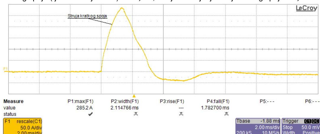
5.7. Učinjen je kratki spoj između "+" i "-" sabirnica na stezaljkama -X5:19<sup>+</sup>,22<sup>-</sup> u ormaru +NE5 , koji je spojen na stezaljke -X2:87,88 koje se nalaze u ormaru spojnog polja +NK1, iza zaštitnog prekidača -Q146.
