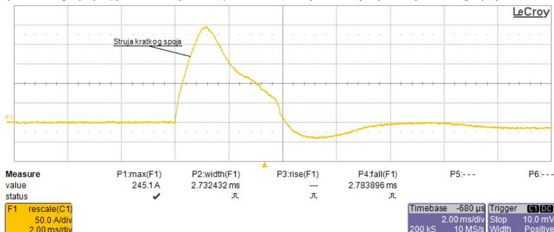
5.6. Učinjen je kratki spoj između "+" i "-" sabirnica u ormaru +RO-N (nužna rasvjeta), koji je spojen na stezaljke -X2:95,96 koje se nalaze u ormaru spojnog polja +NK1 i nalaze se iza zaštitnog prekidača -Q139/2.
